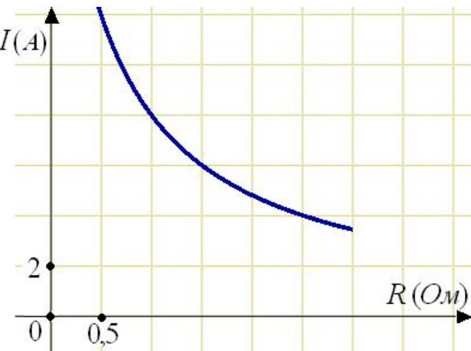
тродвигателя – чем меньше сопротивление, тем больше сила тока и тем быстрее вращается мотор отопителя. На рисунке показана зависимость силы тока от величины сопротивления. На оси абсцисс откладывается сопротивление (в Омах), на оси ординат – сила тока в Амперах. На сколько ампер изменится сила тока, если увеличить сопротивление с 0,5 Омов до 1,5 Омов?
